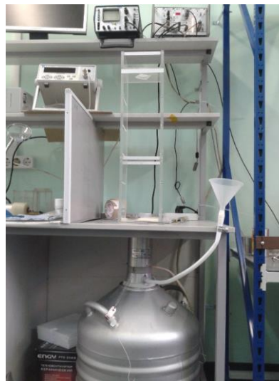
Спектрометр рентгеновского и гамма- излучения Dsрec-50 ORTEC
