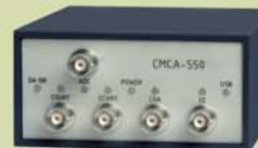
CMCA-550 Модуль накопления данных для MCS и PNA. Два окна, установленные в режиме PNA, могут быть использованы в режиме MCS
